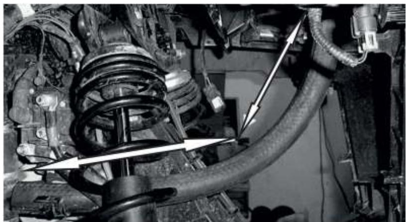
10. Установить вынос радиатора в крайнее нижнее положение, наметить необходимую длину патрубка от углового переходника к тройнику системы охлаждения. При регулировке угла наклона патрубок не должен перегибаться и уменьшаться в сечении.
