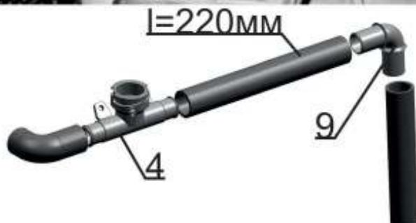
11. Обрезать штатный патрубок (отмечен цифрой 3 в пункте 4) так, чтобы он соединял радиатор с тройником поз.4. С обратной стороны тройника вставить отрезок патрубка d25 длиной 220 мм, в патрубок вставить угловой переходник поз. 9. Остаток патрубка d25 вставить в угловой переходник.
