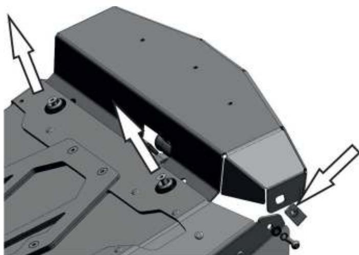
15. Вставить клевые гайки M6 поз.22 в панель поз. 2. Открутить на 3-4 оборота верхние винты крепления радиатора к выносу. Завести панель в вынос радиатора. Закрепить панель к выносу винтами M6x20 поз.18 через шайбы 6 поз.24,25.
