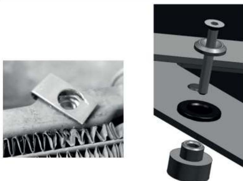
5. Вставить клевые гайки М6 поз.22 в радиатор. Вставить втулки резиновые поз. 15 в короб выноса поз. 1. Закрепить радиатор в коробе выноса винтами M6x45 поз. 19 через шайбы 6 специальные поз.6 и алюминиевые втулки поз. 7
