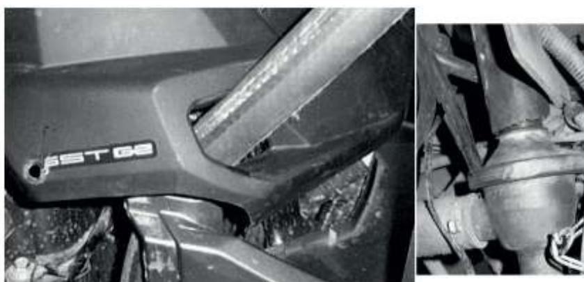
12. Провести патрубок через пластиковую накладку панели приборов, предварительно вырезав в ней отверстие, к термостату системы охлаждения. Отметить необходимую длину патрубка d25: во всех положениях выноса радиатора патрубок d25 не должен перегибаться и уменьшаться в сечении, при этом его длина должна обеспечивать полную регулировку угла наклона выноса радиатора.
