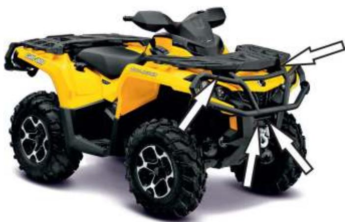
2. Снять передний бампер. Открутить 4 винта, указанные стрелкой. Для удобства откручивания нижних винтов необходимо снять клюз лебедки
