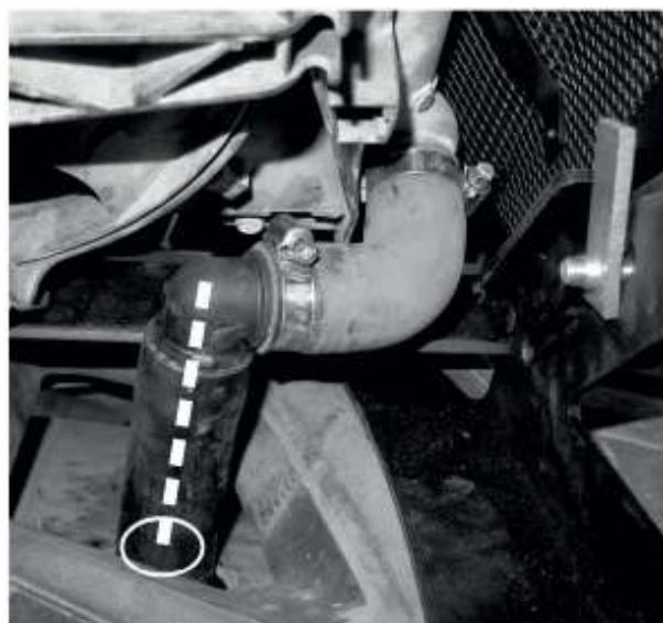
9. Установить вынос радиатора в среднее положение по углу наклона. Установить ранее снятый угловой патрубок(отмечен цифрой 1 в пункте 4) в радиатор, вставить в патрубок угловой переходник поз. 9. Наметить отверстие в капоте при вертикальном положении углового переходника. Просверлить отверстие для прохода патрубка d25.
