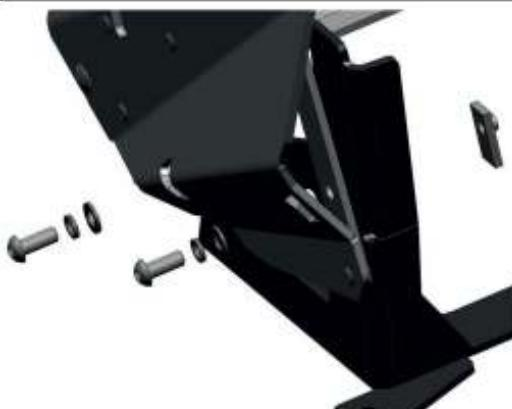
8. Установить короб выноса радиатора поз.1 на кронштейны поз.3. Закрепить винтами M8x30 поз.20 через шайбы 8 поз. 26,27 и гайками закладными M8 поз.5
