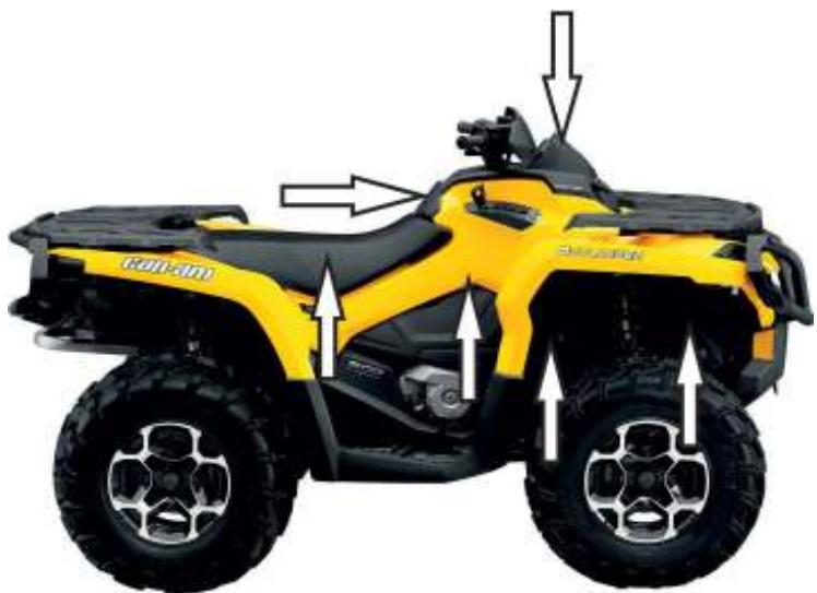
1. Снять пластиковые подкрылки с обеих сторон. Снять сидение, пластиковую накладку на воздушном фильтре, пластиковую накладку на панель приборов. Пластиковые панели с обеих сторон от сидения. Для демонтажа пистонов рекомендуется использовать специальный съемник
