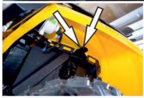
3. Снять передний багажник. Открутить винты, указанные стрелкой с обеих сторон.
