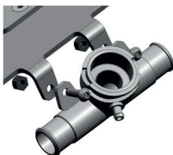
6. Установить тройник с горловиной поз. 4 на коробе выноса. Крепить винтами M6x20 поз.18 и гайками M6 поз. 23. Крышку со штатного расширительного бачка установить на тройник с горловиной.
