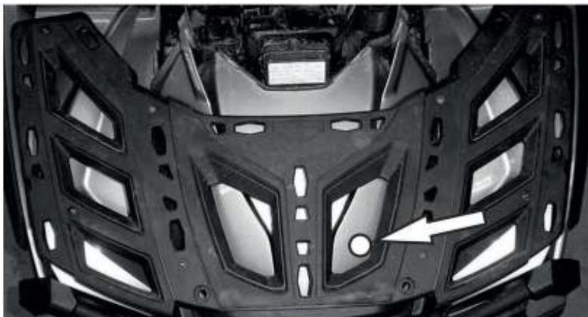
14. Просверлить изнутри отверстие в пластиковом капоте для вывода проводки подключения вентилятора. Подключить вентилятор в штатный разъем
