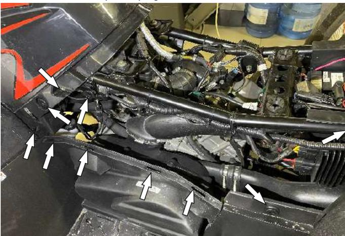
Снять левую боковую панель. Крепится на штырях в резинках и пазах. Открутить болты облицовки топливного бака.
