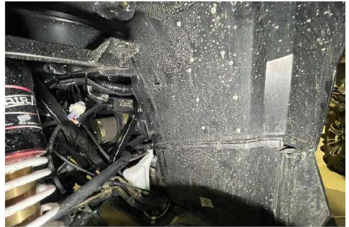
Снять левую внутреннюю панель
