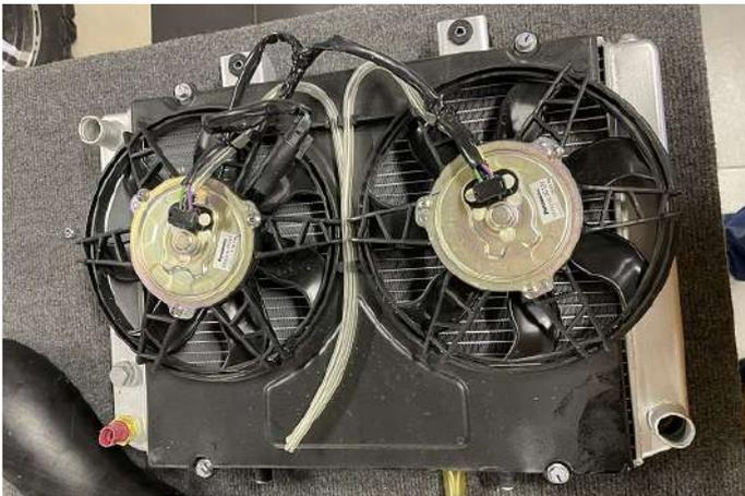
Переложить разъем подключения вентиляторов к низу радиатора. Закрепить проводку хомутами
