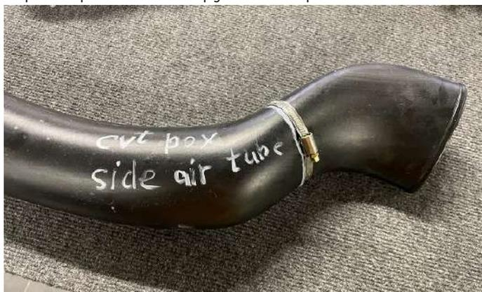
На боковом штатном шноркеле закрутить хомут, в месте, близком по форме круга. Как на фото. Хомут обжать до начала деформации трубы..
