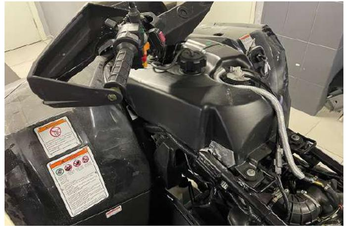
Открутить крышку горловины топливного бака. Снять облицовку топливного бака.
