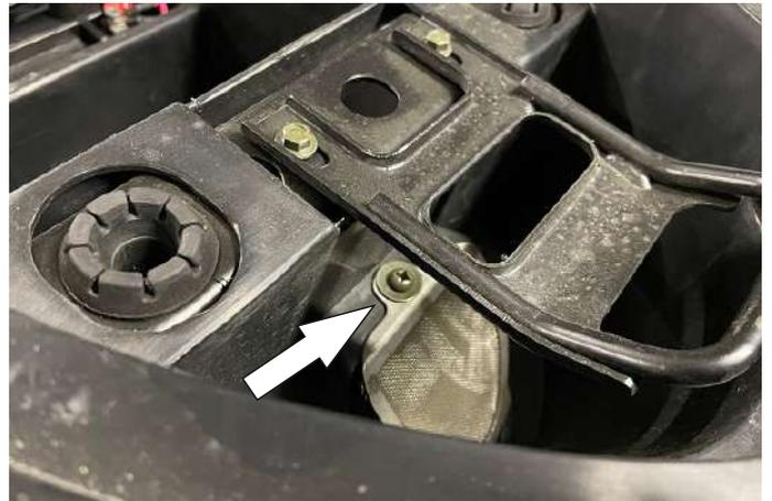
Открутить винт крепления бокового патрубка шноркеля вариатора
