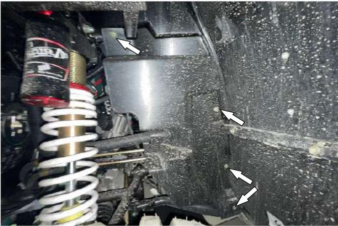
В левой передней арке. Открутить болты крепления левой внутренней панели и левой части передней облицовки.
