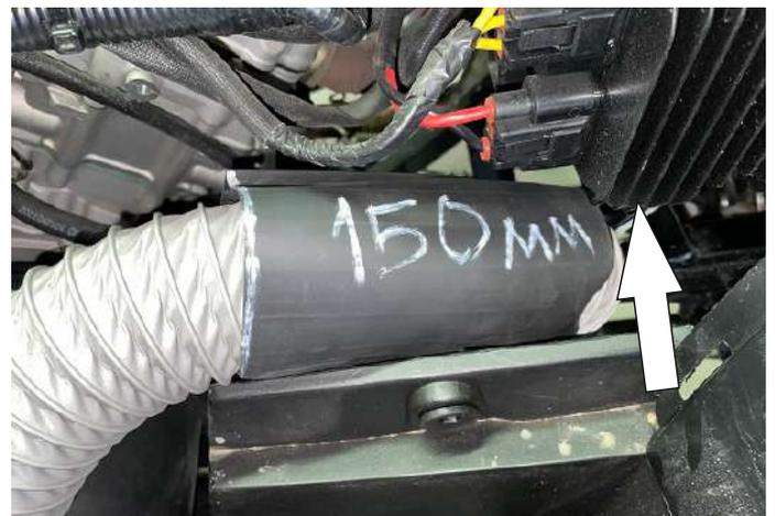
Часть термоусадочной трубки установить на боковой гофре, в месте контакта с реле-регулятором.
