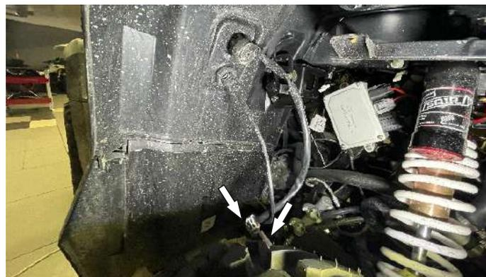
Отключить разъемы прикуривателя и замка зажигания. Снять правую внутреннюю панель
