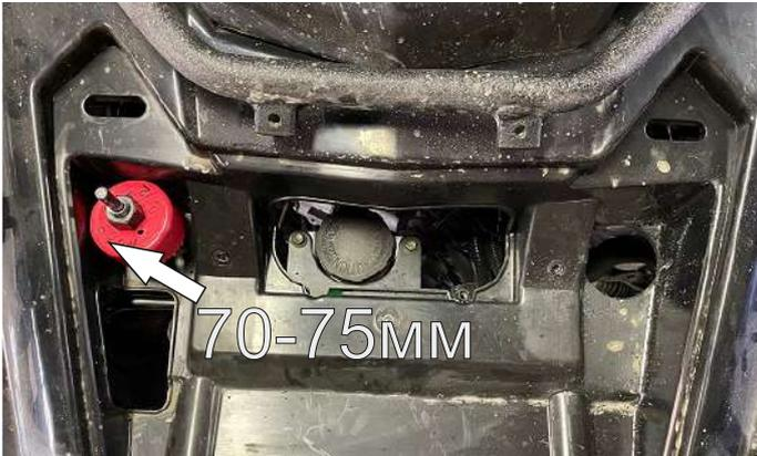
В верхней части передней ниши просверлить отверстие 70-75мм.
