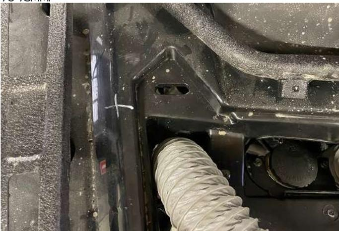
Проложить гофру через раму в средней и левой частях за пластиком и вывести в передней части, где расположена ниша под передней багажной платформой
