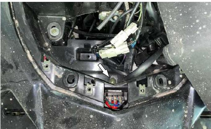
Открутить винт передней облицовки под приборной панели. Снять приборную панель.
