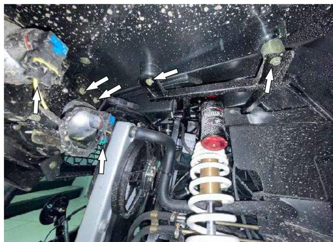
Открутить болты крепления передней багажной платформы. Снять платформу. Открутить болты крепления фар. Отсоединить разъемы ламп фар.
