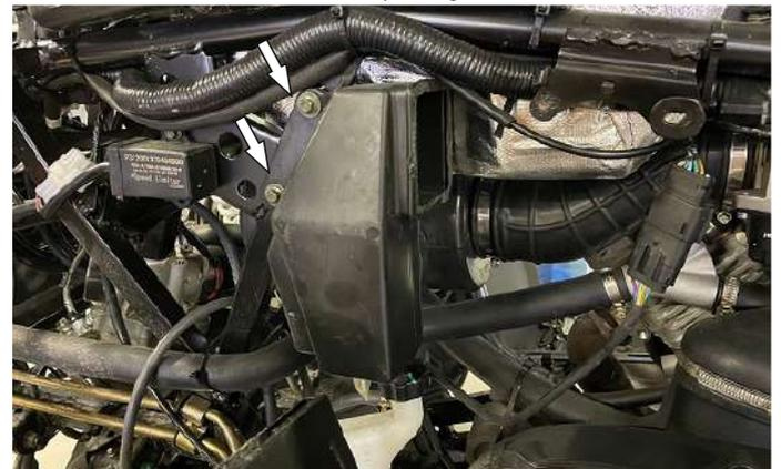
Открутить болты и хомут штатного воздухозаборника. Снять его.
