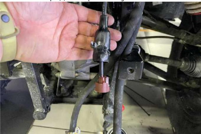
Разъем на датчик температуры радиатора требует удлинения провода
