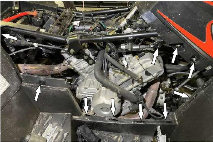
Снять правую боковую панель. Крепится на штырях в резинках и пазах. Открутить болты крепления облицовки топливного бака.
