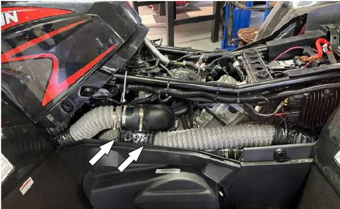
Часть термоусадочной трубки установить на боковой гофре, выход с воздушного фильтра, в месте контакта с другими частями шноркелей.
