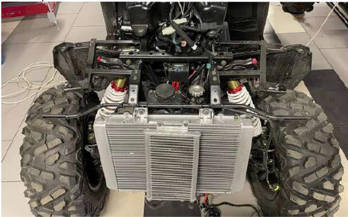
Снять переднюю облицовку вместе с фарами. Сначала сдвинуть вперед и поднять вверх. Контролировать разъемы и реле в средней части приборной панели.
