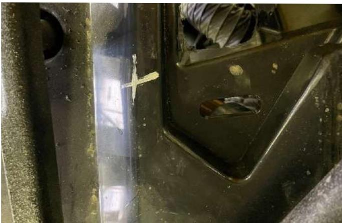
Разметить точку для сверления отверстия. Прямая ребра пластика и кромки в нише. Как на рисунке.
