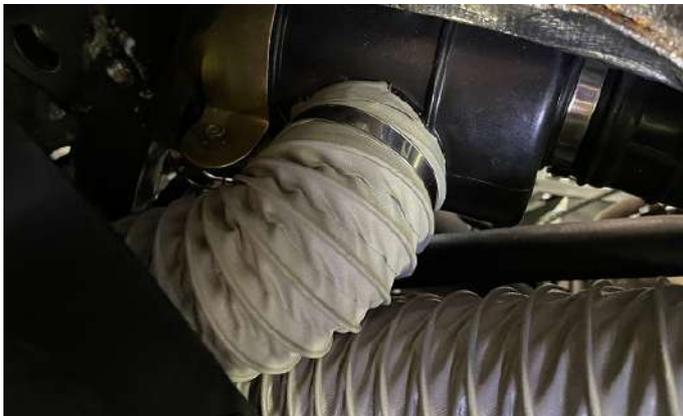
Одеть край гофры на корпус воздушного фильтра. Закрепить штатных хомутом.
