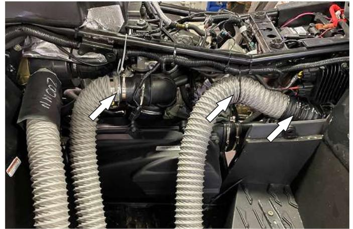
Закрепить конструкции шноркелей короба вариатора пластиковыми хомутами.
