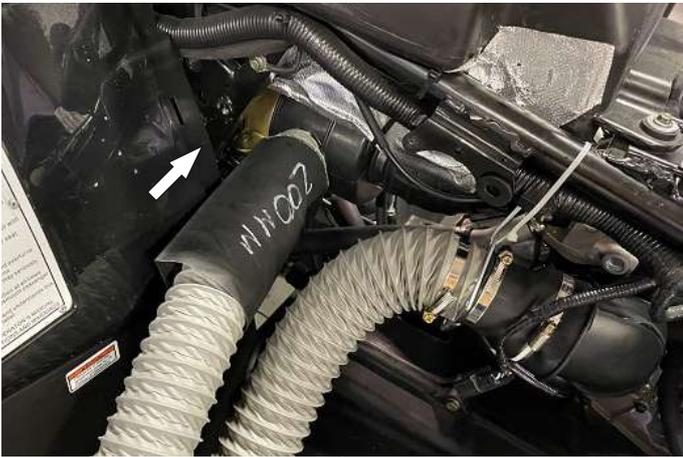
Часть термоусадочной трубки установить на гофре, выход с воздушного фильтра, в месте контакта с боковым пластиком.
