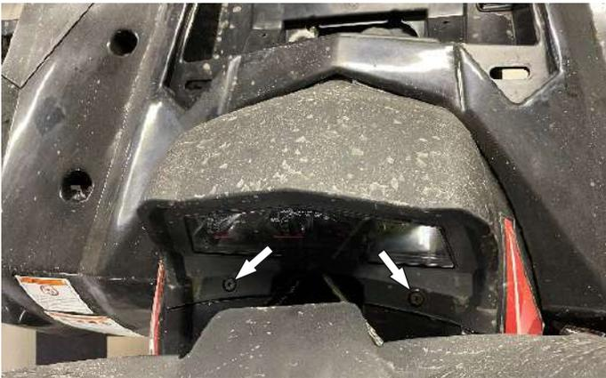
Открутить болты корпуса приборной панели
