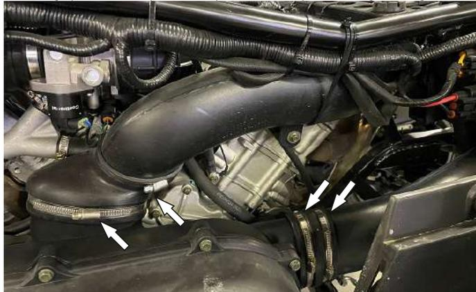
Открутить хомуты крепления штатных шноркелей вариатора. Снять патрубки шноркелей.
