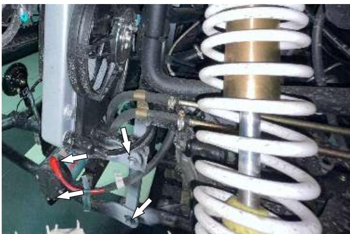
Открутить гайки силовых проводов лебедки. Открутить болты крепления переднего бампера
